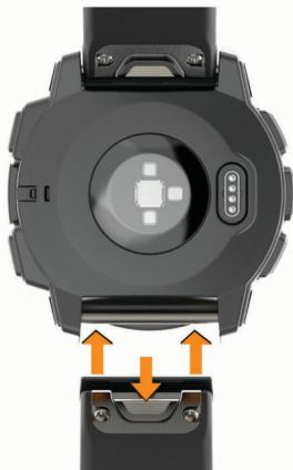
**ПРИМЕЧАНИЕ.** убедитесь, что ремешок закреплен надежно. Фиксатор должен защелкнуться на штырьке часов.
